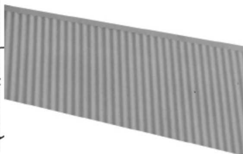
YTTERVÄGG AV MATRISGJUTNA BETONG-ELEMENT MED SINUSKURVAD YTA
